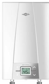
Chauffe-eau instantané à commande électronique pour l'alimentation en eau chaude dans des pays aux conditions de raccordement électrique équivalentes. Selon la tension disponible, la puissance connectée est de 6,6 ou 8,8 kW. L'appareil dispose donc d'une puissance suffisante pour chauffer entre 3 à 5 l/min d'eau chaude entre 20 °C et 55 °C. L'appareil est particulièrement efficace avec le système de chauffage à fil nu.
