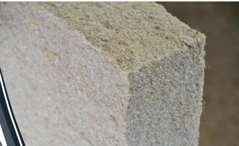
Biofib' ouate est un isolant à base de fibres naturelles de chanvre et de ouate (cellulose recyclée) tout spécialement adapté à l'isolation thermo-acoustique des bâtiments d'habitation et tertiaires. Il est conditionné sous forme de panneaux semi-rigides de 45, 100, 120 et 140 mm. Biofib' ouate est principalement utilisé pour l'isolation thermique et acoustique des murs, toitures et planchers, en neuf comme en rénovation.
